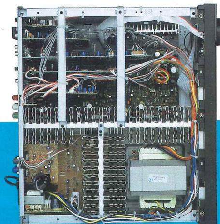
La filatura interna non è delle più ridotte ma è molto ordinata, grazie al massiccio uso di fascette fermacavo; il telaio è irrobustito con una coppia di staffe orizzontali che sovrastano le schede di ingresso/uscita.
