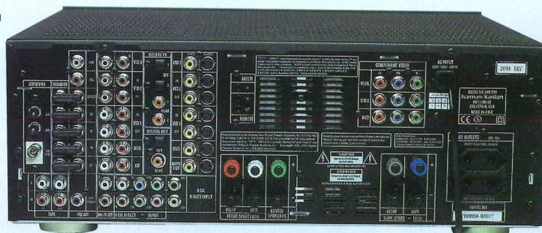
con tale tipo di ingressi. La sezione multiroom è realizzata rendendo disponibile un'uscita audio a due canali da collegare a un amplificatore esterno; grazie alla presenza dei collegamenti per un sensore esterno IR da posizionare nel secondo ambiente è possibile comandare l'AVR 5500 dalla postazione
